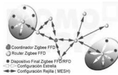
Fig. 4 Topología ZigBee (Fuente: Glen et al., 2012)
