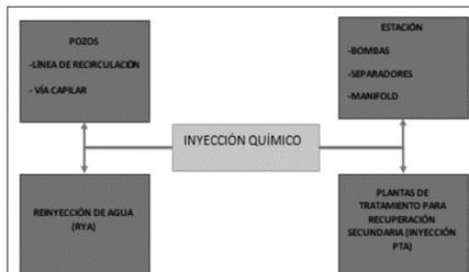
Fig.2: Puntos de Inyección de Químicos
