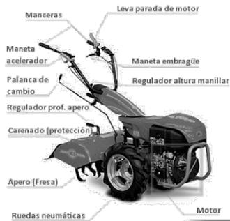
Fig. 2. Partes del motocultor (21).
