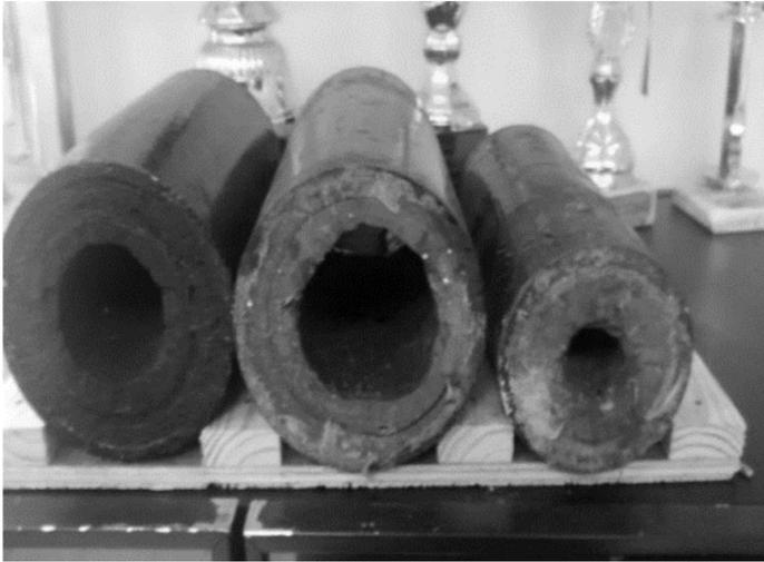
Fig. 1: Corte de Tuberías y efectos por la inyección inadecuada de químicos (Departamento de Producción Secoya)
