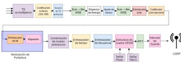
Fig. 5. Diagrama de bloques Transmisor del Sistema. Fuente: El Autor
